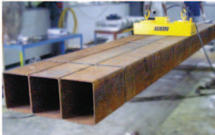
〈각파이프 이송용으로 사용시〉 when used for transfer of square pipes
